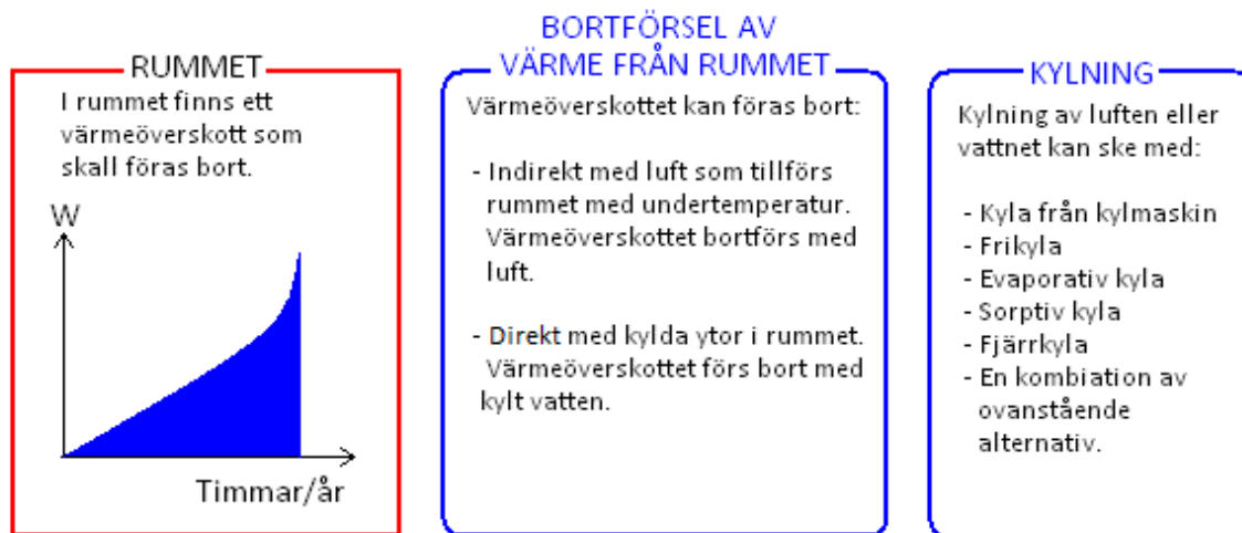
Figur 5. Process för bortförel av överskottsvärme. Källa: Abel, Elmroth, 2007.
